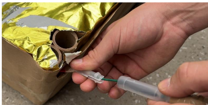
Etape 3 : Insérer la mèche dans le connecteur qui relie l'allumeur électrique.
