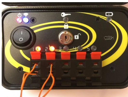
Ici les modules 1 et 2 sont correctement connectés.
