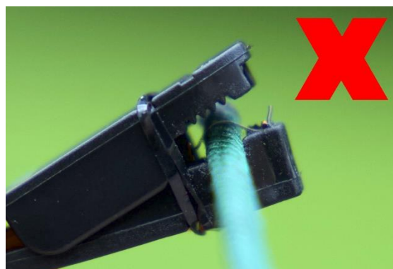
Faux : la mèche est installée en dessous du filament. Elle ne brûlera pas.
