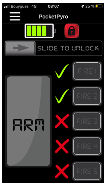
Ici les modules 1 et 2 sont correctement connectés.
